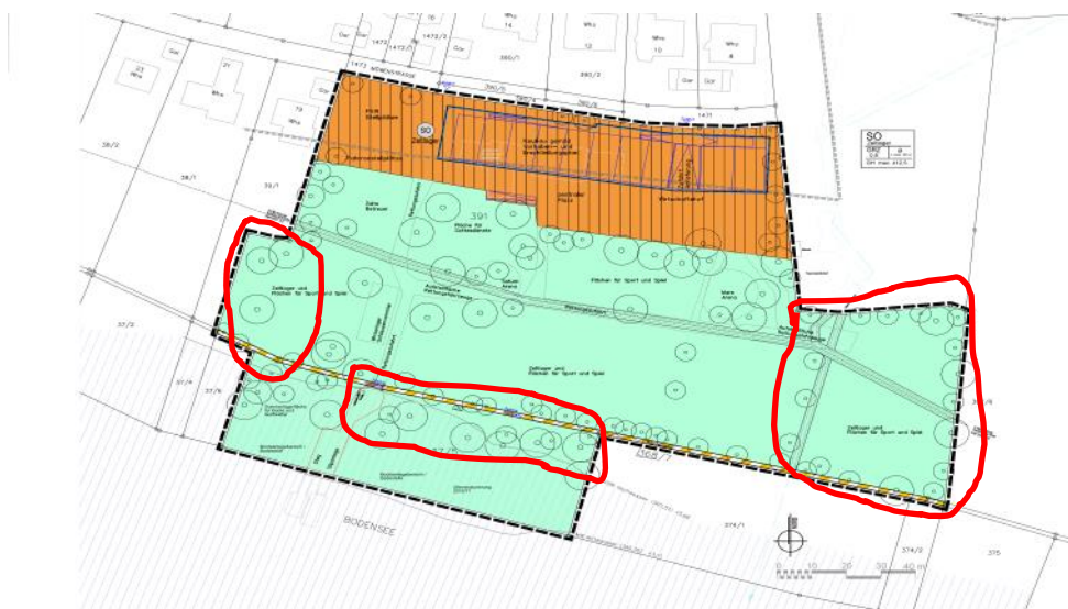
Abb. 20: Bereiche für die Anbringung von Fledermauskästen
